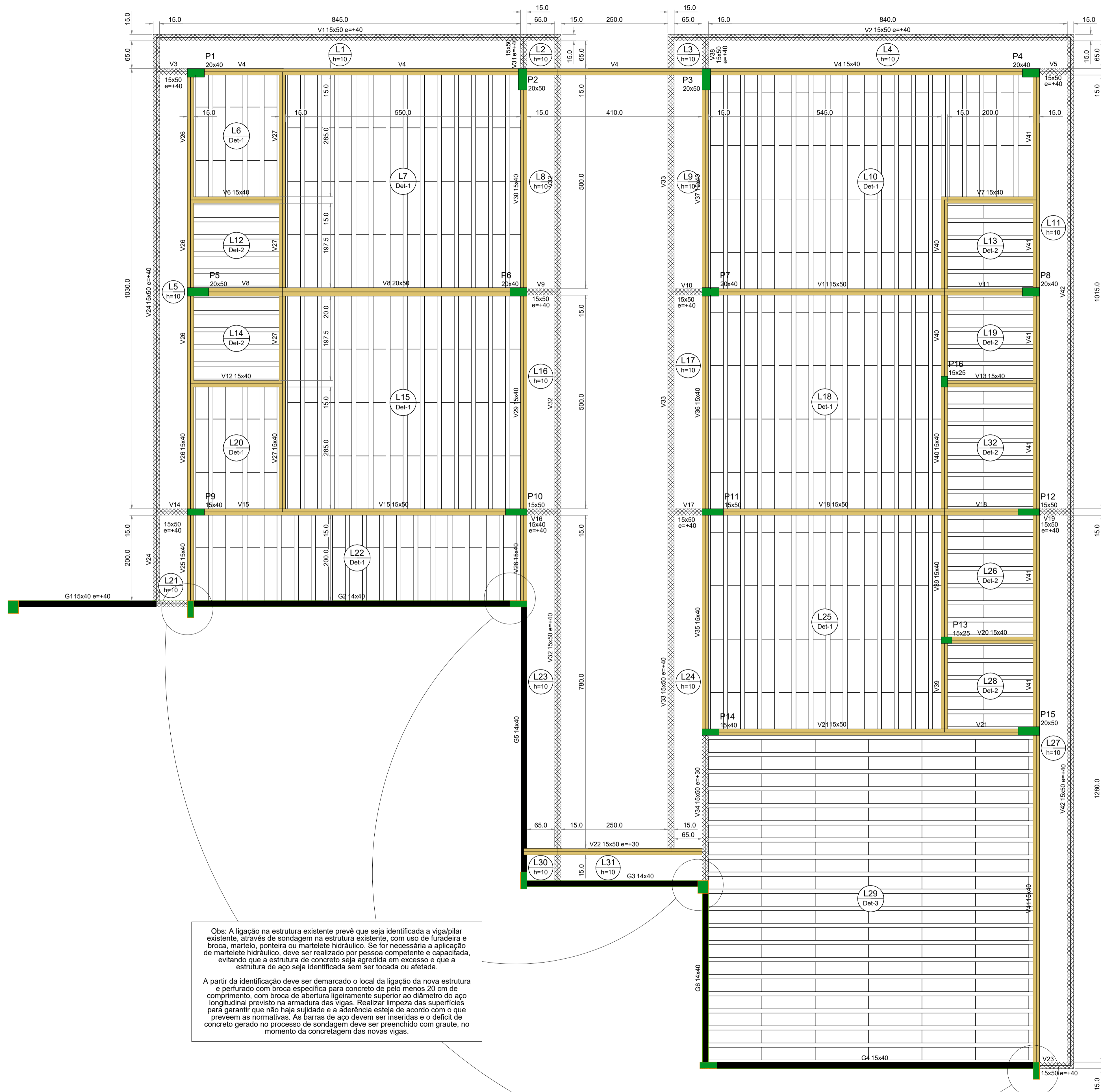
Forma do pavimento Laje Fechamento (Nível 314) escala 1:50
