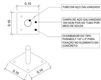
6 DETALHE - FIXAÇÃO DA ESTRUTURA DO ALAMBRADO
